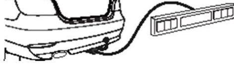
3- Connecter les fils d'entrée (1 à 7) du SBS sur chacun des fils des feux arrière gauche du véhicule sans se soucier des fonctions.
